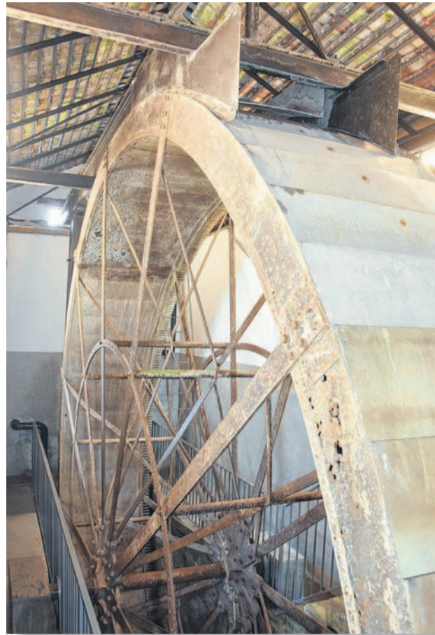
Eine erste Etappe der Renovation des Wasserrads in der Neumühle in Wollerau ist abgeschlossen. In einem nächsten Schritt muss mehr als die Hälfte der Schaufeln ersetzt werden, weil sie durchgerostet sind.
